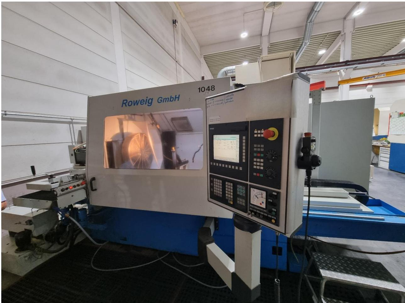
Hochwertige CNC-Innenrundschleifmaschine für das Schleifen von zylindrischen, konischen, einfachen und gestuften Bohrungen, kurzen Außendurchmessern und Stirnflächen
